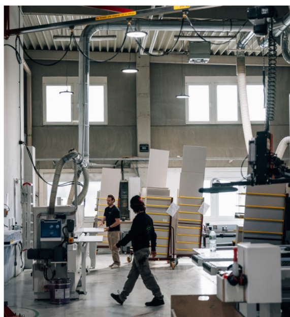
In de productie wordt gewerkt met een CNC-machine van HOMAG. De CNC-gegevens worden daarbij rechtstreeks vanuit Palette CAD doorgestuurd naar SmartWOP.
