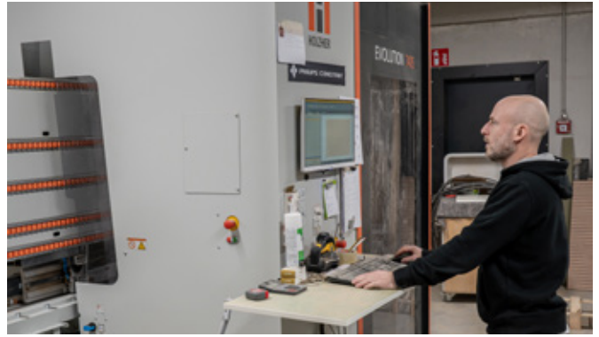
CNC-gegevens worden direct vanuit het ontwerp gegenereerd en overgedragen.
